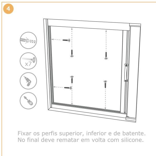
Fixar os perfis superior, inferior e de batente. No final deve rematar em volta com silicone.
