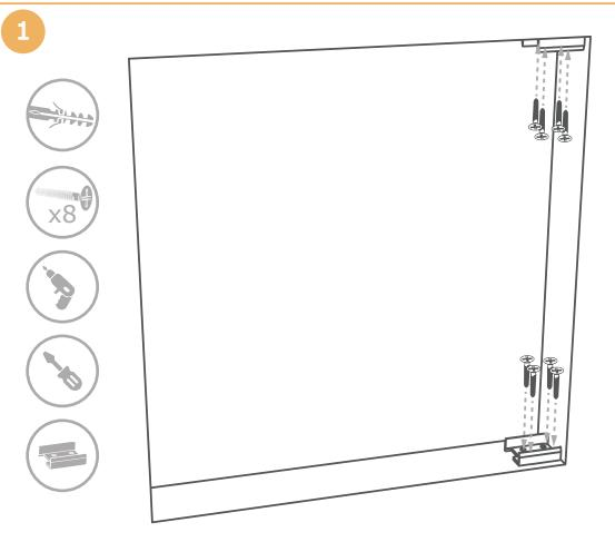
Fixar os 2 suportes do cofre dentro do vão da janela, tendo em conta que a ranhura fica para o interior.
