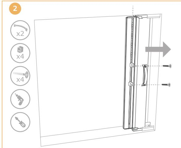
Inserir os suportes do puxador no perfil base e aparafusar os respectivos puxadores. Encaixar o cofre com a rede nos suportes.
