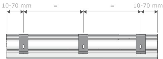
Coloque os suportes no local pretendido, considerando que deve existir uma distância entre 10 a 70 mm entre o limite externo e o primeiro suporte.
