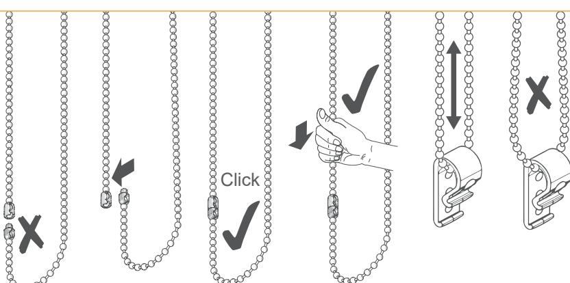
Ajuste o cordão para que fique bem esticado sem baloiçar, através do conector de corrente.
