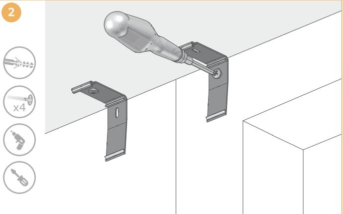
Considere ainda que também deve existir uma distância mínima de 15 mm entre a parede ou janela e o suporte. De seguida, apafuse-os e encaixe as tampas para ocultação dos parafusos e proteção do tecido.
