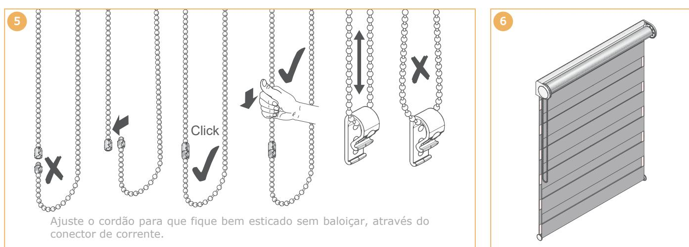
Ajuste o cordão para que fique bem esticado sem baloiçar, através do conector de corrente.
