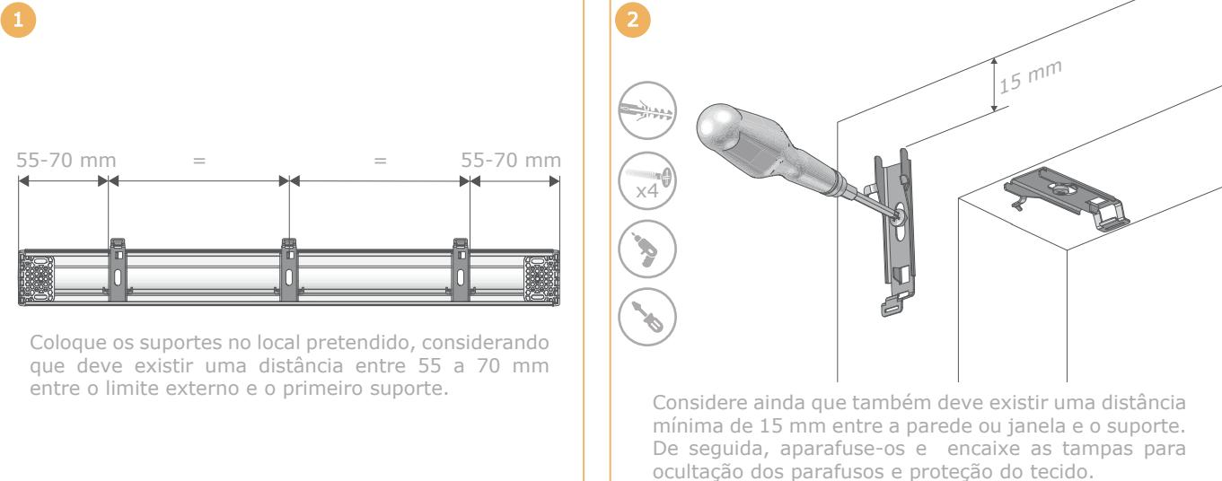
Coloque os suportes no local pretendido, considerando que deve existir uma distância entre 55 a 70 mm entre o limite externo e o primeiro suporte.
