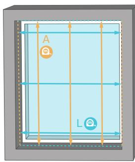
Esta instalação é possível apenas quando a janela é de correr e o vão livre tem uma profundidade mínima de 65 mm a partir do puxador. As medidas de execução devem ser do vão livre, ou seja do buraco, deduzindo 10 mm à largura e 10 mm à altura.
