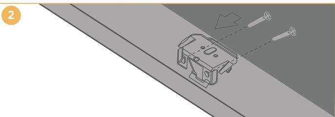
Aparafuse os clipe na parede.
