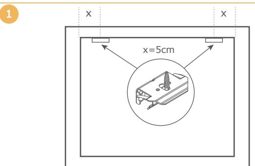
Coloque os perfis de encaixe a meio dos 5cm para dentro do vão.
