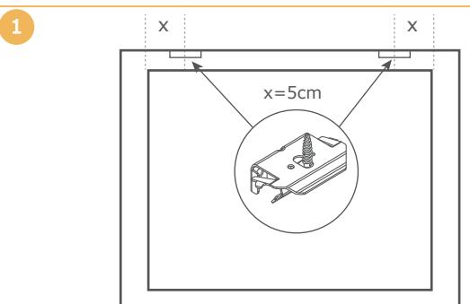
Coloque os perfis de encaixe a meio dos 5cm para fora do vão.
