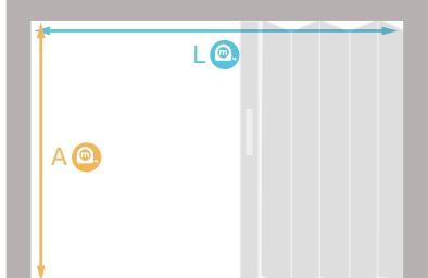
Medir a largura total da parte superior do vão e a altura do vão, onde deseja colocar a Porta de Fole.
