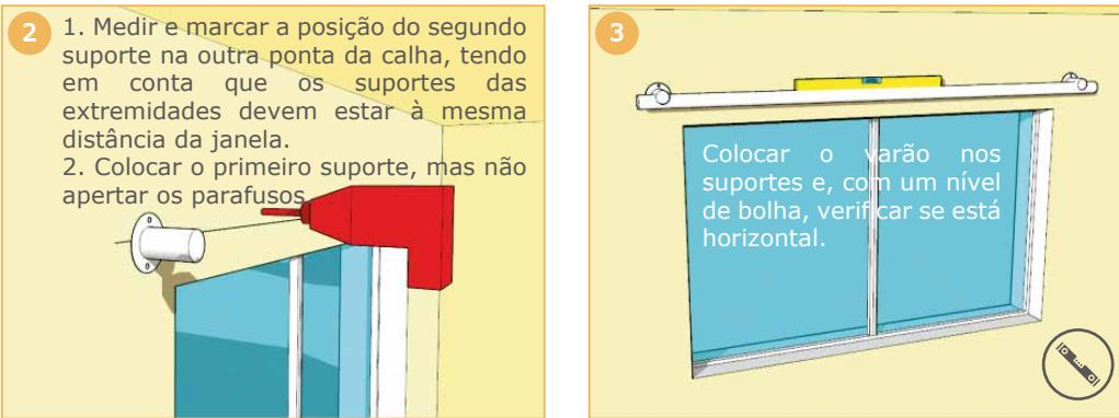
2. Medir e marcar a posição do segundo suporte na outra ponta da calha, tendo em conta que os suportes das extremidades devem estar à mesma distância da janela.
