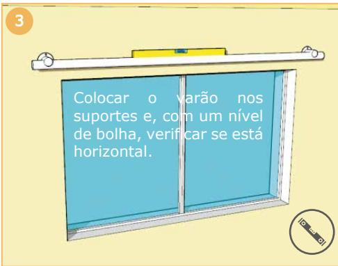
3. Colocar o varão nos suportes e, com um nível de bolha, verificar se está horizontal.
