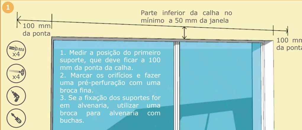
1. Medir a posição do primeiro suporte, que deve ficar a 100 mm da ponta da calha. Parte inferior da calha no mínimo a 50 mm da janela.
