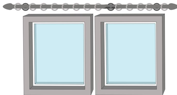
A união de varões é colocada entre os dois varões adquiridos juntamente com um suporte adicional.
