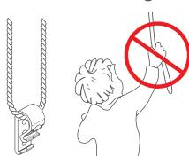
É fornecido um dispositivo que permite fixar a corrente à parede, evitando acidentes com crianças.
