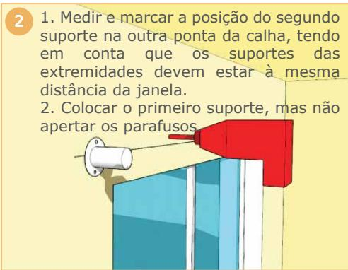
2. Medir e marcar a posição do segundo suporte na outra ponta da calha, tendo em conta que os suportes das extremidades devem estar à mesma distância da janela.
